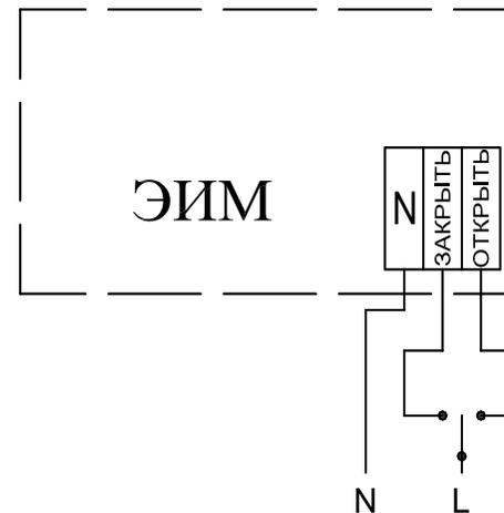
Рисунок 3 - Схема подключения
