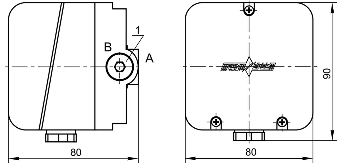
Рис. 26-2. Габаритные размеры датчиков-реле избыточного давления (напора) серии ДРД-Н
