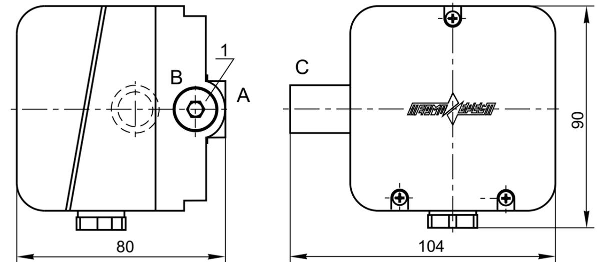
Рис. 26-3. Габаритные размеры датчиков-реле вакуумметрического давления (тяги) серии ДРД-Т
