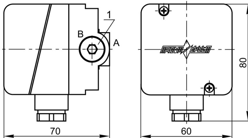
Рис. 26-1. Габаритные размеры датчиков-реле давления серии ДРД
