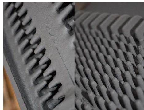
Рисунок 1. Внешний вид поверхностей теплообменника
