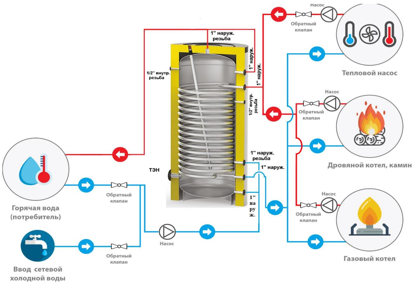
Область применения – накопление и аккумулирование нагретой санитарной воды от Теплового насоса либо котлов высокой мощности.
