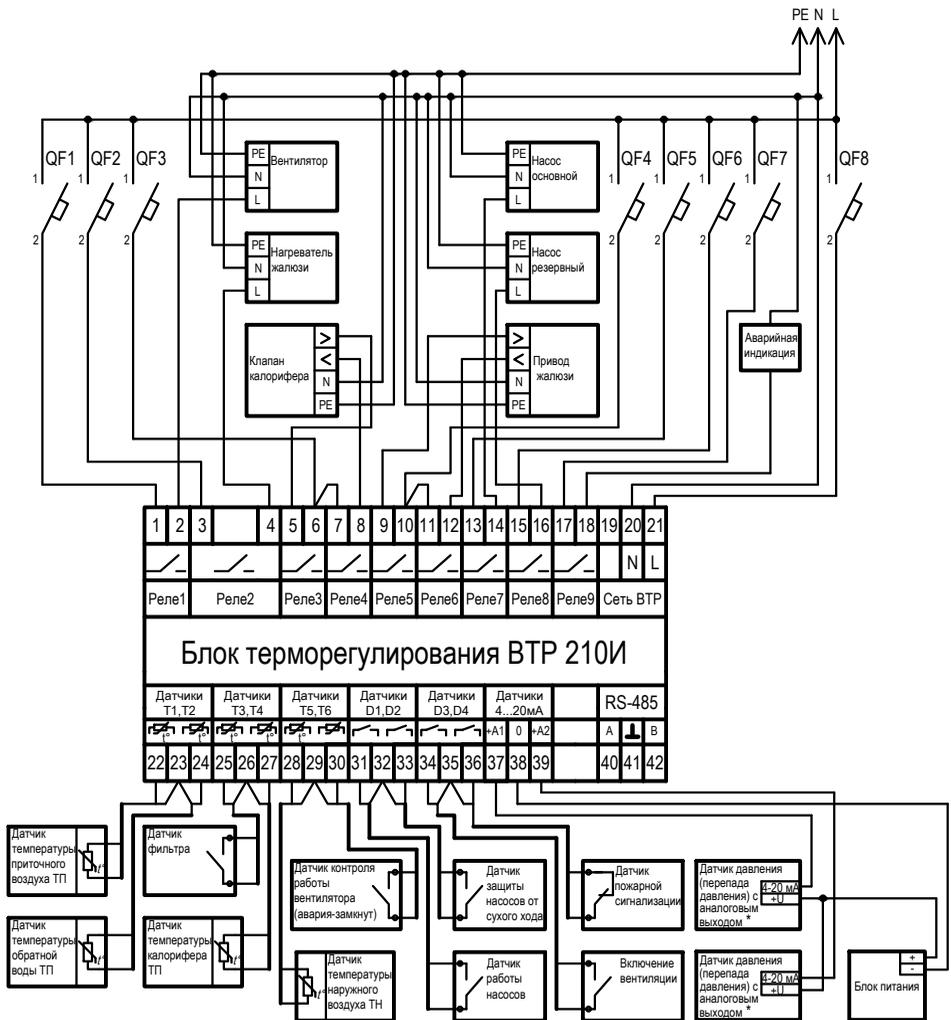
**Рисунок В.10-Схема подключения регулятора ВТР 210И (программа 33) в системе управления приточной вентиляцией**
