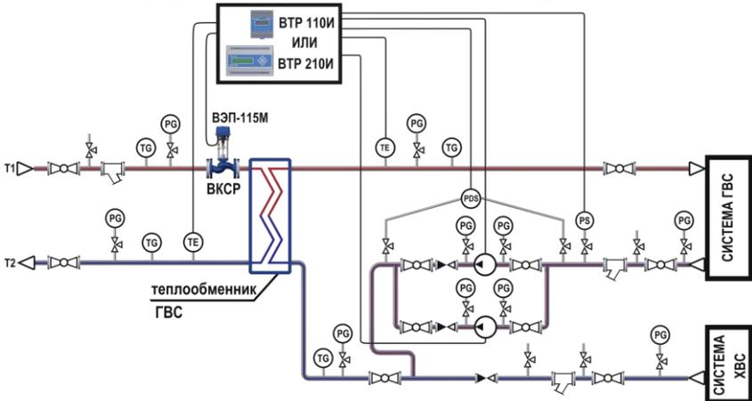
Рисунок Б.2 – Монтажная схема регулятора ВТР 210И (программа 20) в системе управления одним контуром ГВС
