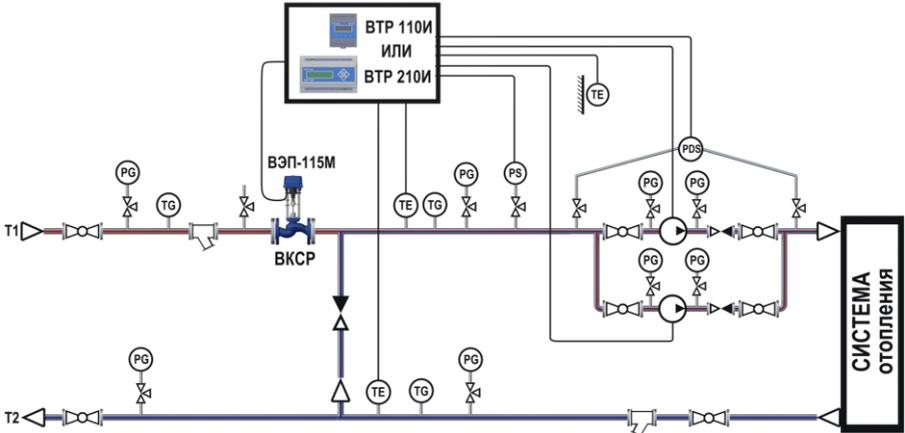
Рисунок Б.1 – Монтажная схема регулятора ВТР 210И (программа 10) в системе управления одним зависимым контуром отопления
