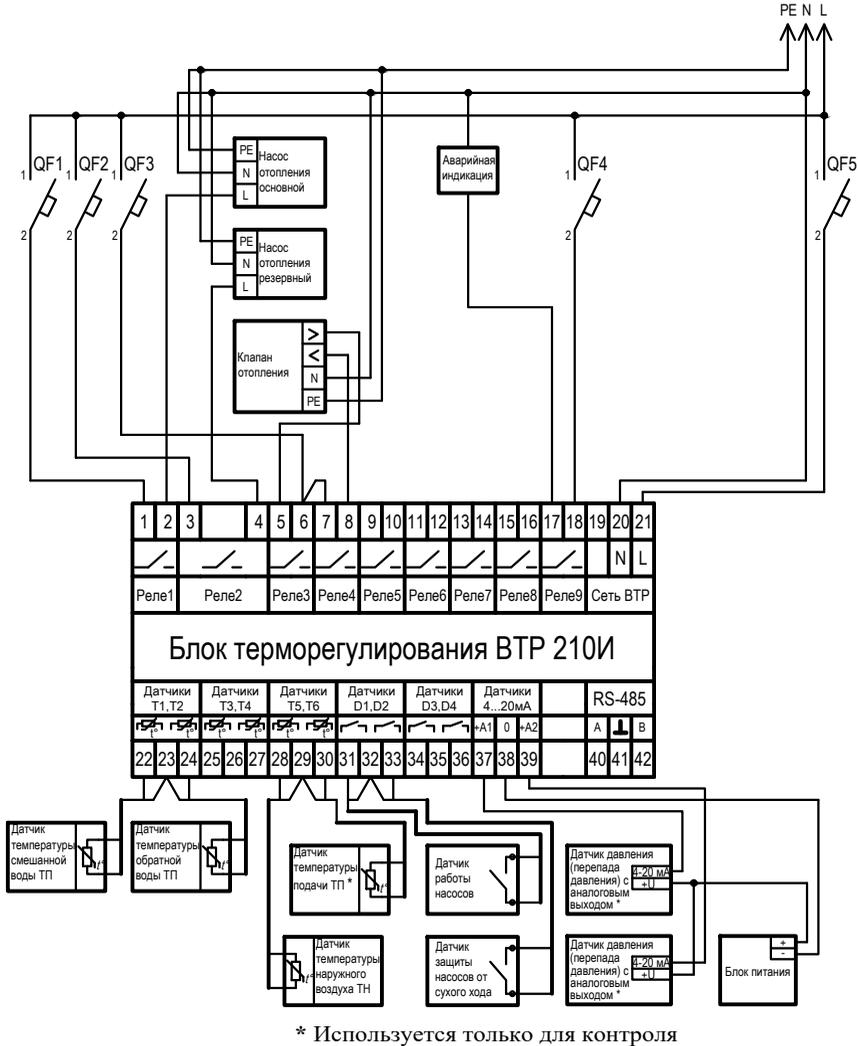
**Рисунок В.1-Схема подключения регулятора ВТР 210И
