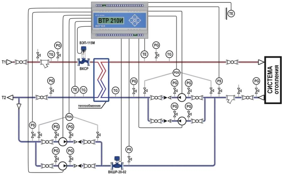
**Рисунок Б.3 – Монтажная схема регулятора ВТР 210И (программа 14) в системе управления одним независимым контуром отопления и контуром подпитки**
